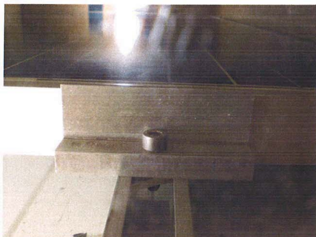
Figure 5 : Système de fixation après essai cyclique de 50 cycles avec le panneau 2
