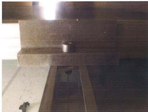
Figure 7 : Système de fixation après les essais de charge accrue
